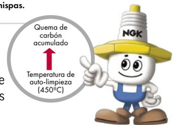
**NOTA:** La frontera entre las regiones de carbonización y de operación óptima (450° C) se denomina temperatura de autolimpieza de la bujía. Esta es la temperatura a la que los sedimentos acumulados son quemados y desprendidos de las partes de la bujía.
