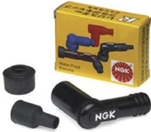
Son utilizados en motocicletas, scooters, podadoras, generadores y motores fuera de borda para asegurar un óptimo desempeño. Los capuchones deben soportar altas temperaturas, vibración, proteger contra el agua y ayudar en la prevención del efecto "Flash Over".
